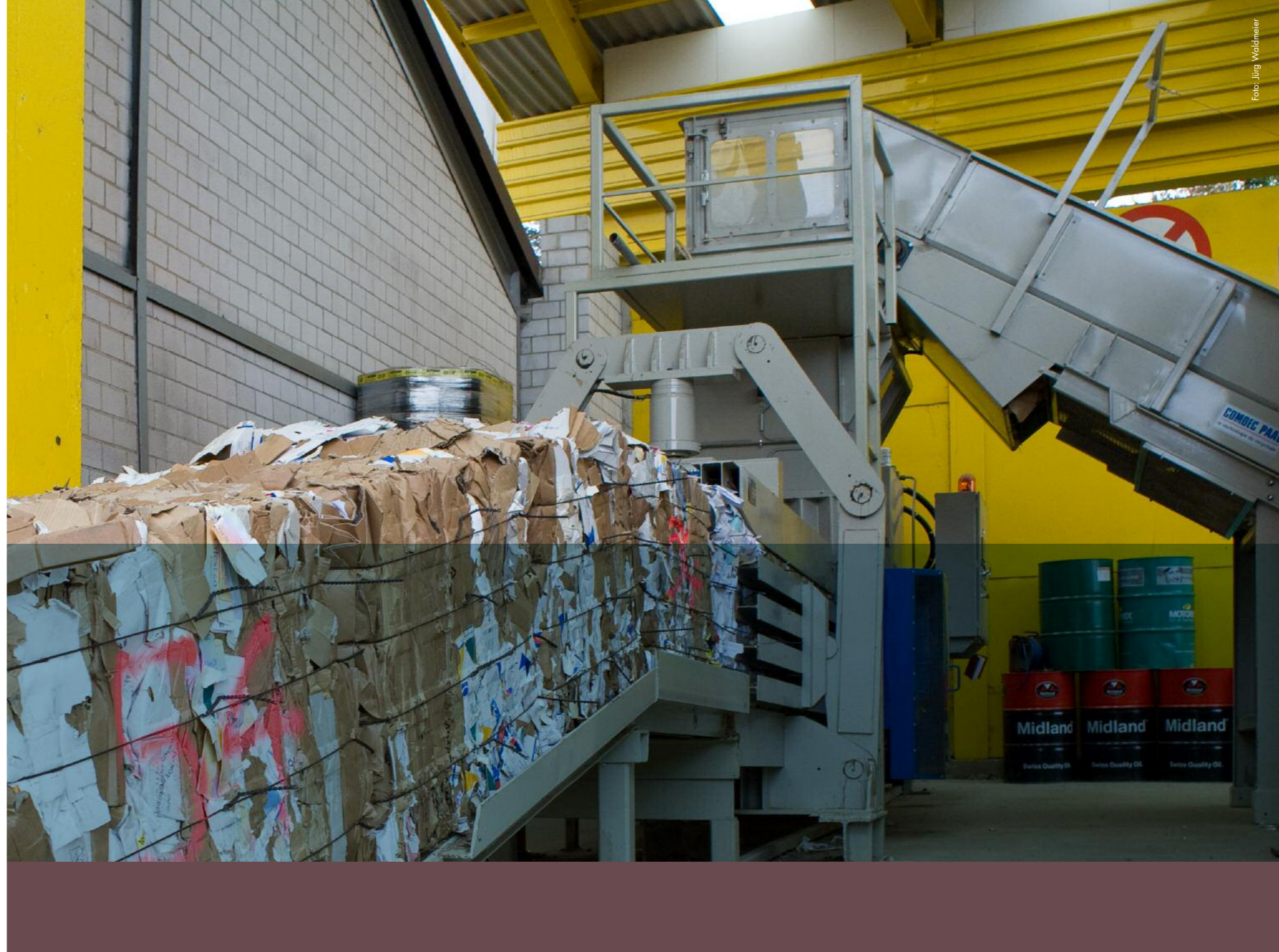
Leasingobjekt Kanalballenpresse: Sie ermöglicht es, Karton oder Plastikfolie zu platzsparenden Ballen zu pressen.
