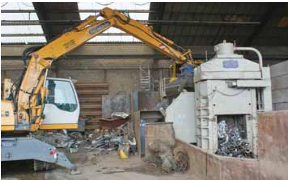
Die 650-Tonnen-Schrottschere macht aus Alteisen, Trägern usw. Sekundärrohstoffe für Stahlwerke und Giessereien.
