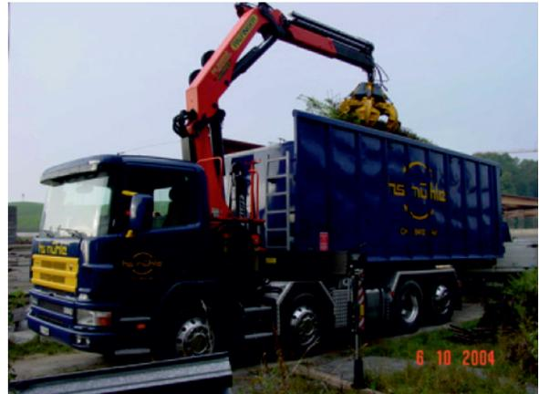
Im Zuge der Erneuerung unserer Fahrzeugflotte haben wir unseren ersten Scania in Betrieb genommen. Mit dem 20mt-Tonnen-Kran, einer Hubkraft von 2 Tonnen bei 10,5 m Reichweite sowie einer Funksteuerung für rationellen Verlad, kombiniert mit einem Hakengerät für Container bis 40 m3 Inhalt sind wir gut gerüstet.
