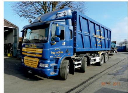
Unsere Tochterunternehmung Hs. Mühle GmbH entwickelt sich ebenfalls erfreulich und hat dieses Jahr einen neuen Renault mit Kehrrechtsammelaufbau und integrierter Waage in Betrieb nehmen können. Dieses Fahrzeug wird für Grüngutsammlungen eingesetzt und verfügt deshalb über einen geschlossenen Aufbau. Der Motor ist zusätzlich mit Partikelfilter ausgerüstet.
